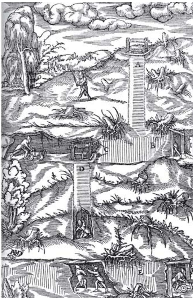
Fig. 4.4 Distintos tipos de pozos según las planchas del libro de Agricola “De Re Metallica”
